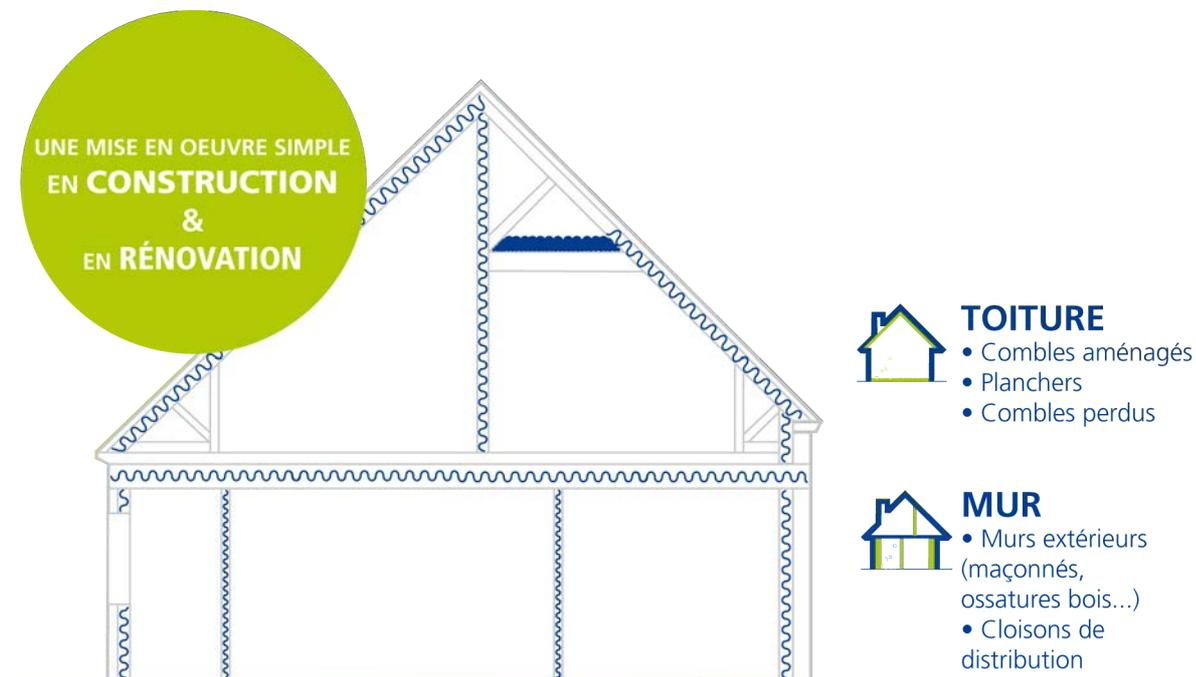
Quelle que soit la nature du projet - isoler de la toiture (combles aménagés, planchers, combles perdus) ou des murs (murs extérieurs maçonnerie ou à ossature bois, cloisons de distribution) - l'étendue de la gamme Métisse® permet de répondre à chaque besoin : panneau, rouleau, flocons, bourrelet calorifuge, baffle<sup>4</sup>...
